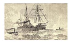
Un torpilleur est un petit navire de guerre relativement rapide et manœuvrant, chargé de combattre les grosses unités navales de surface en utilisant, comme arme principale, la torpille. Ce type de navire n'existe plus aujourd'hui car, trop spécialisé, il a été dépassé. Il a été remplacé par les
